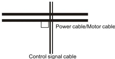
*Fig. 3-14 orthogonal wiring*
